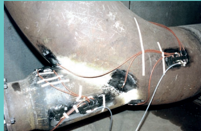
von oben nach unten Warmgehender Rohrbogen mit Axialabstützung: Messung mittels Dehnungsmessstreifen und Simulation
