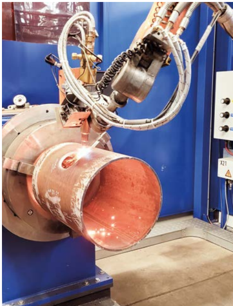
Herstellung Abzweig-T-Stück mittels Brennroboter
